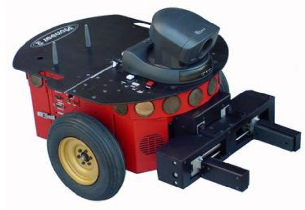
La porta seriale presente sul corpo del robot mette a disposizione la possibilità di controllare il robot in velocità e di ricevere informazioni sull'odometria.
